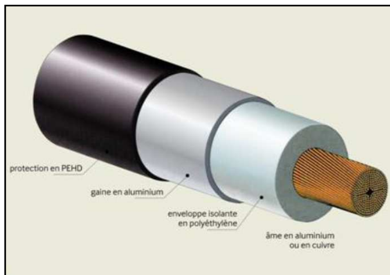
Schéma du câble électrique souterrain
